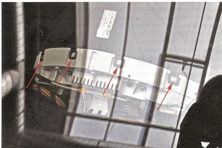
BILD 2: Geclipste Halterungen (Pfeile), die beim Ausbau des Kombiinstrumentes gelöst werden müssen FIGURE 2: Clipped fixtures (arrows) that have to be loosened to remove the instrument cluster
